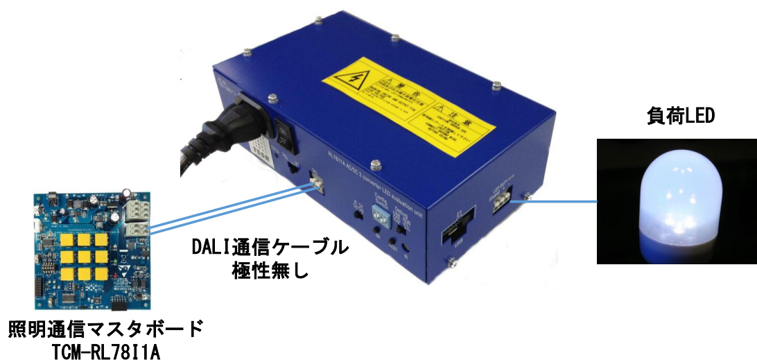
図 3-5 LED 出力評価 (DALI 通信)
