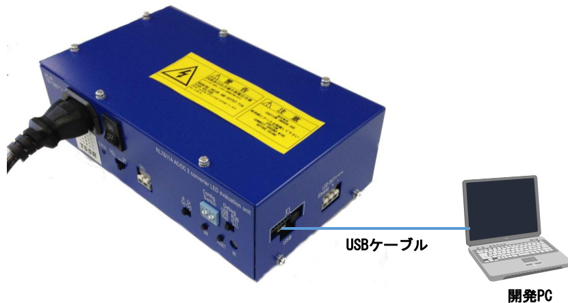
図 3-1 プログラム書込み時の接続(USB インタフェース)
