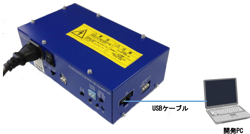
図 3-3 RFP を使用したプログラム書き込み時の接続(USB インタフェース)
