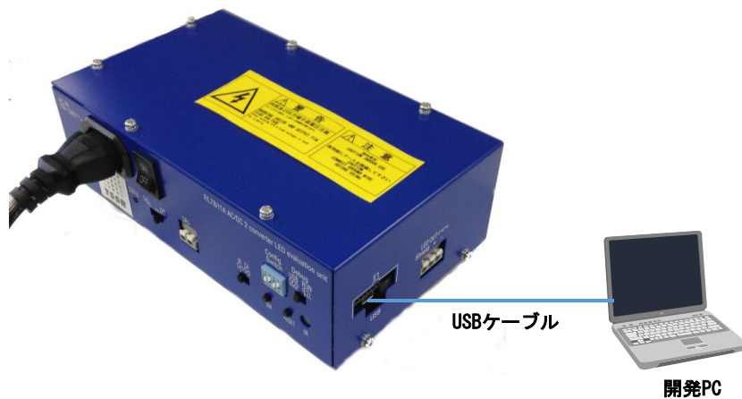
図 3-7 オンチップ・デバッグ時の接続(USB インタフェース)
