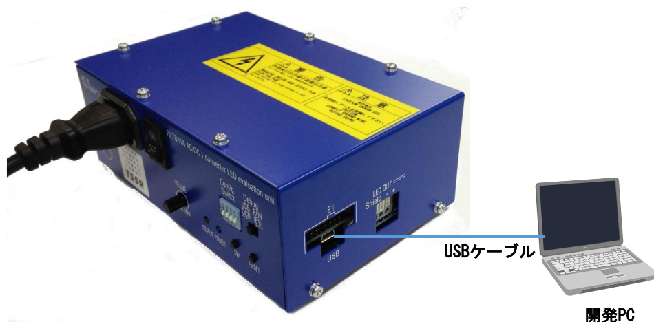
図 3-7 オンチップ・デバッグ時の接続(USB インタフェース)
