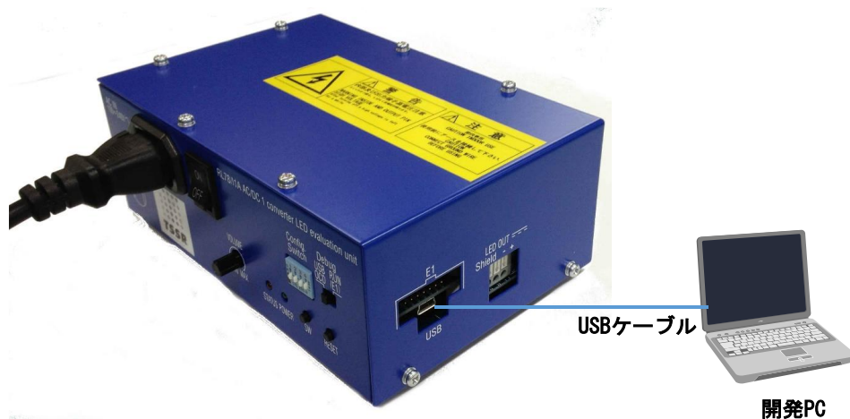
図 3-1 プログラム書込み時の接続(USB インタフェース)
