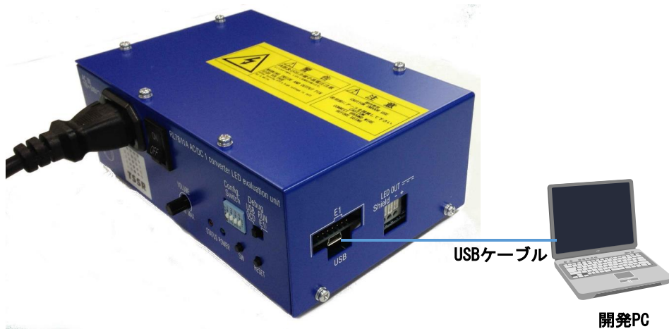
図 3-3 RFP を使用したプログラム書き込み時の接続(USB インタフェース)
