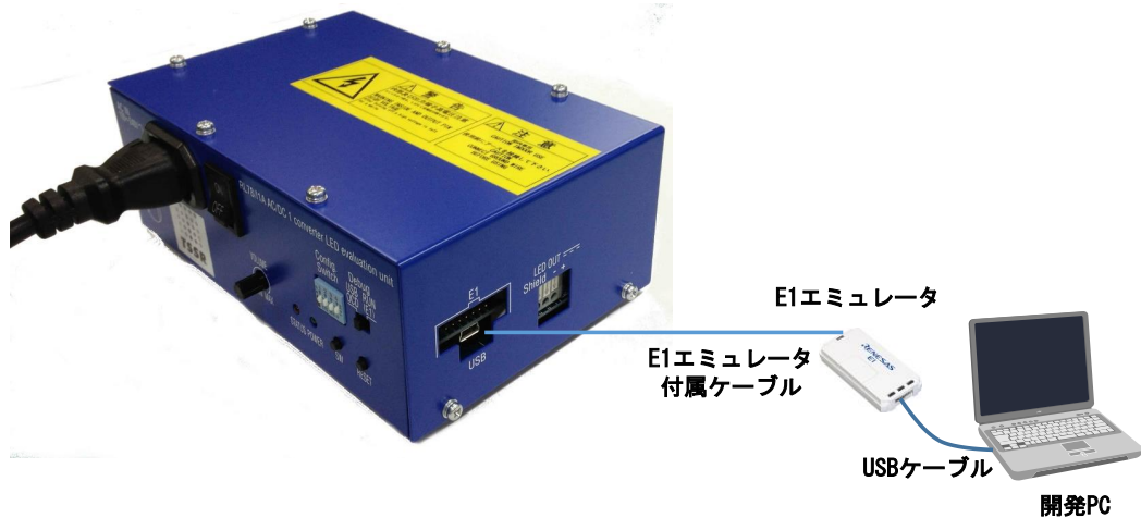
図 3-4 RFP を使用したプログラム書き込み時の接続(E1 インタフェース)
